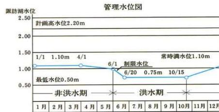
④ 効率的な洪水調節を行うため洪水期には諏訪湖の湖面を常時満水位より 35cm 下げることにより洪水調節容量を 18,730 千ト確保している。水深が浅くなっている改善策として水位を上げる意見がありますが、洪水調節容量を下げることになり治水の観点から好ましくない。
